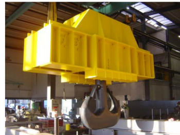
die 150t Hakentraverse mit Doppellasthaken
