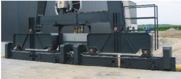
Spezial-Fahrwerk mit 8 Laufrädern und 4 Antrieben pro Seite
