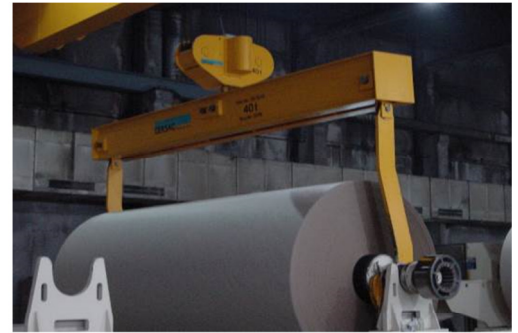
Die Langhaken-traverse kann zwischen den beiden Kranbrücken hochgezogen werden um an Hubhöhe zu gewinnen. Das Ganze ist elektrisch überwacht, dass die Traverse nicht mit den Brücken kollidieren kann.
