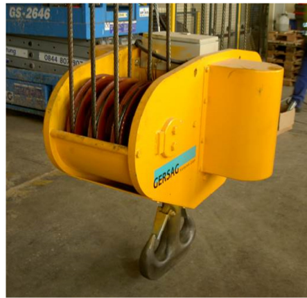
Alleine die drehbare Unterflasche mit Doppelhaken wiegt über 1 Tonne
