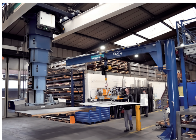
Rüsten von Einzelblechen mit der selbstsaugenden Vakuumaufnahme durch den Schwenkran.
