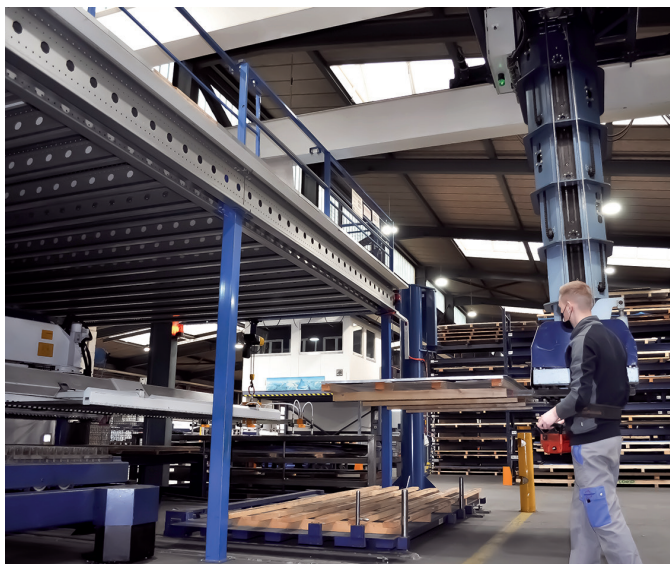
Direktes bestücken der Schneidanlage eines ganzen Blechstapels mit dem Stapelkran.
