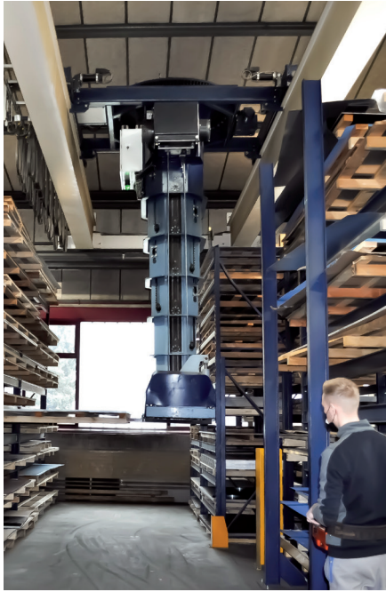
Entnahme von Paletten aus dem Hochregallager mit dem 3,2-t-Stapelkran.
